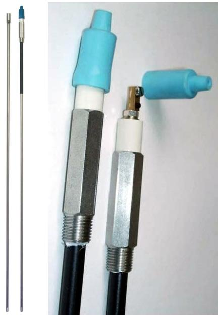
Czujnik montować w króćcu z gwintem R1/4 do zbiorników beciśnieniowych. Na wysięgniku można montować czujnik w otworze z gwintem lub w otworze bez gwintu z użyciem króćca z gwintem R1/4. (dostawa na osobne zamówienie).
