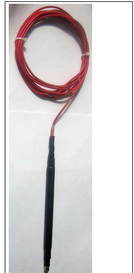
Wymiary i widok czujnika poziomu cieczy - odmiana CZP-1KD... wisz... (przewód LY, elektrody z A2, izol. PEX, dławnica PG11)
